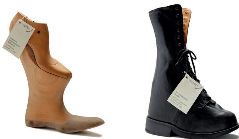
Eine Form aus Holz und ein fertiger orthopädischer Schuh.
